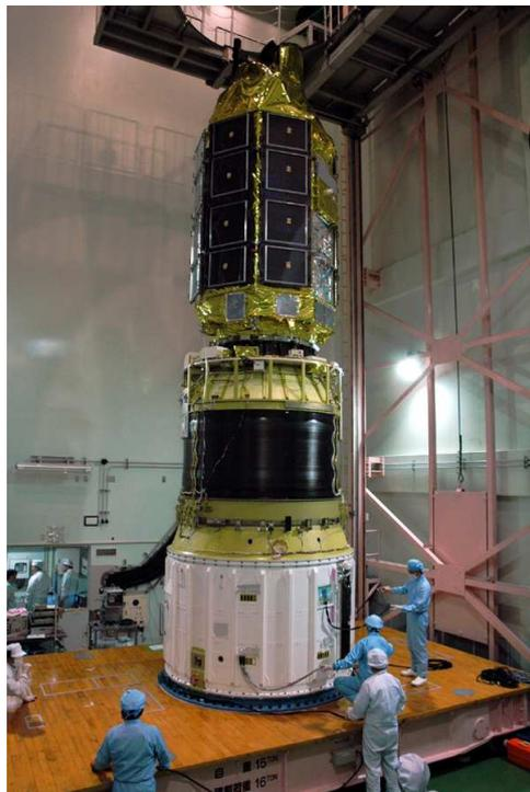
図 1.1: M-V ロケットに結合された SUZAKU 衛星。[12]
