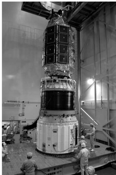
図 2.1: M-V ロケットに結合されたすざく衛星の概観。上半分がすざく衛星である。
